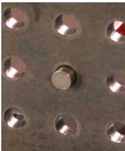
Diameter PRO combina la semplicità con l'intelligenza del controller avanzato iCNC XT per consentire il taglio automatico di fori "ottimizzati" con il semplice clic di un pulsante.
