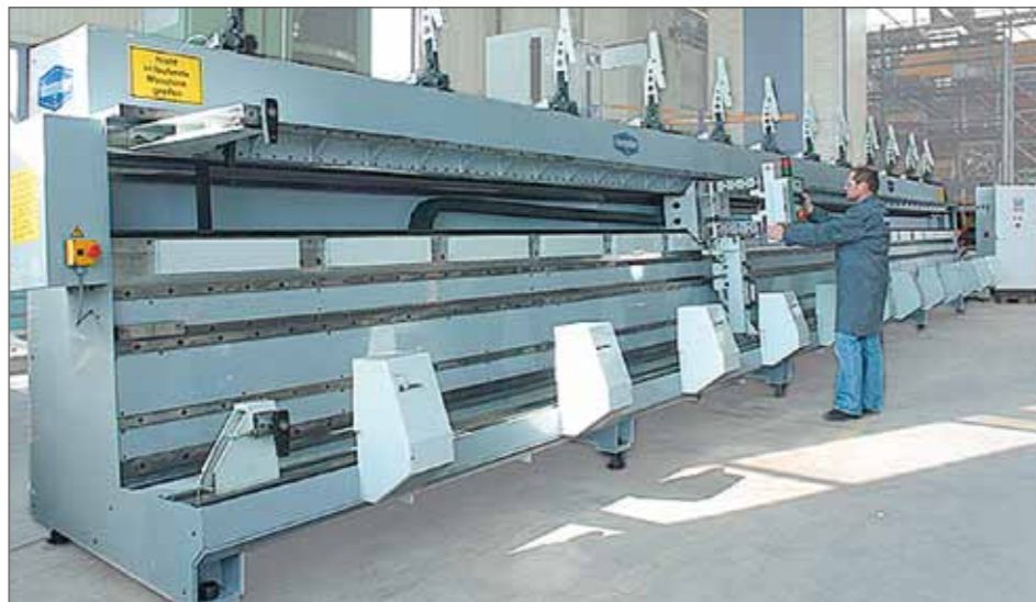
Automatisierte Roboter-Spannvorrichtung für Maschinengrundrahmen
