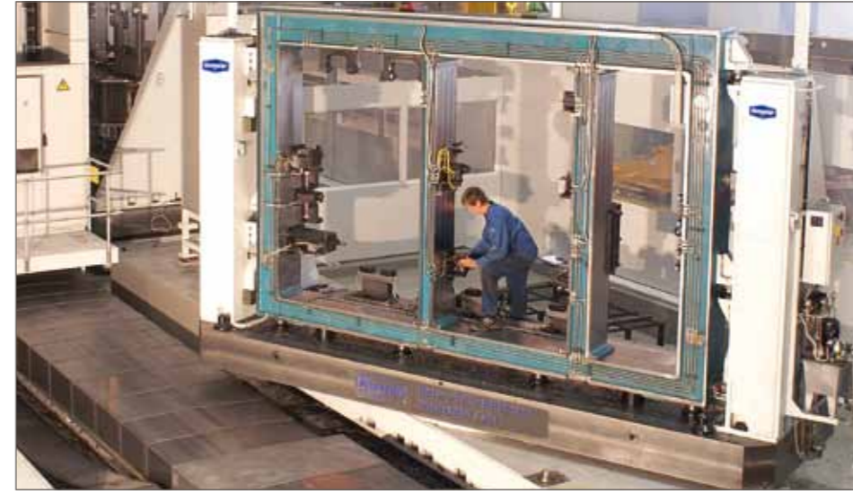
Hochautomatisierte Vorrichtung und Drehtisch aus einer Hand
