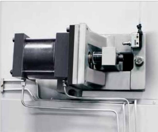
\_Tesa idraulica e automatica della lama per una corretta tesatura della lama. Il sistema mantiene costante la tesatura della lama e la allenta gradualmente quando è spenta per evitare la fuoriuscita e lo stress della stessa.
