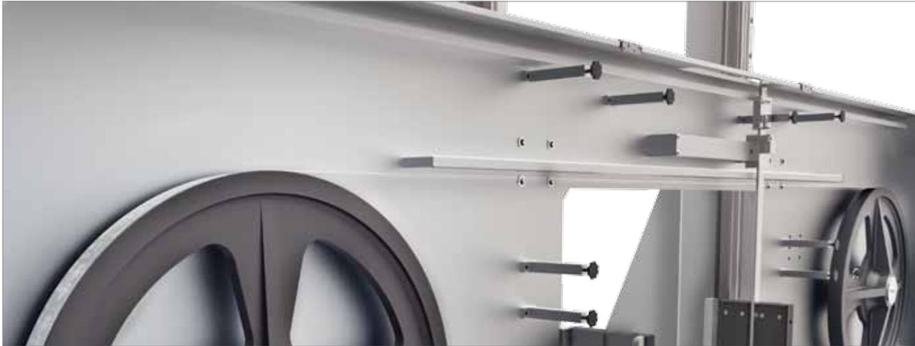
\_Volani in ghisa per la rotazione della lama. Volano motrice montato su uno speciale mandrino del riduttore.
