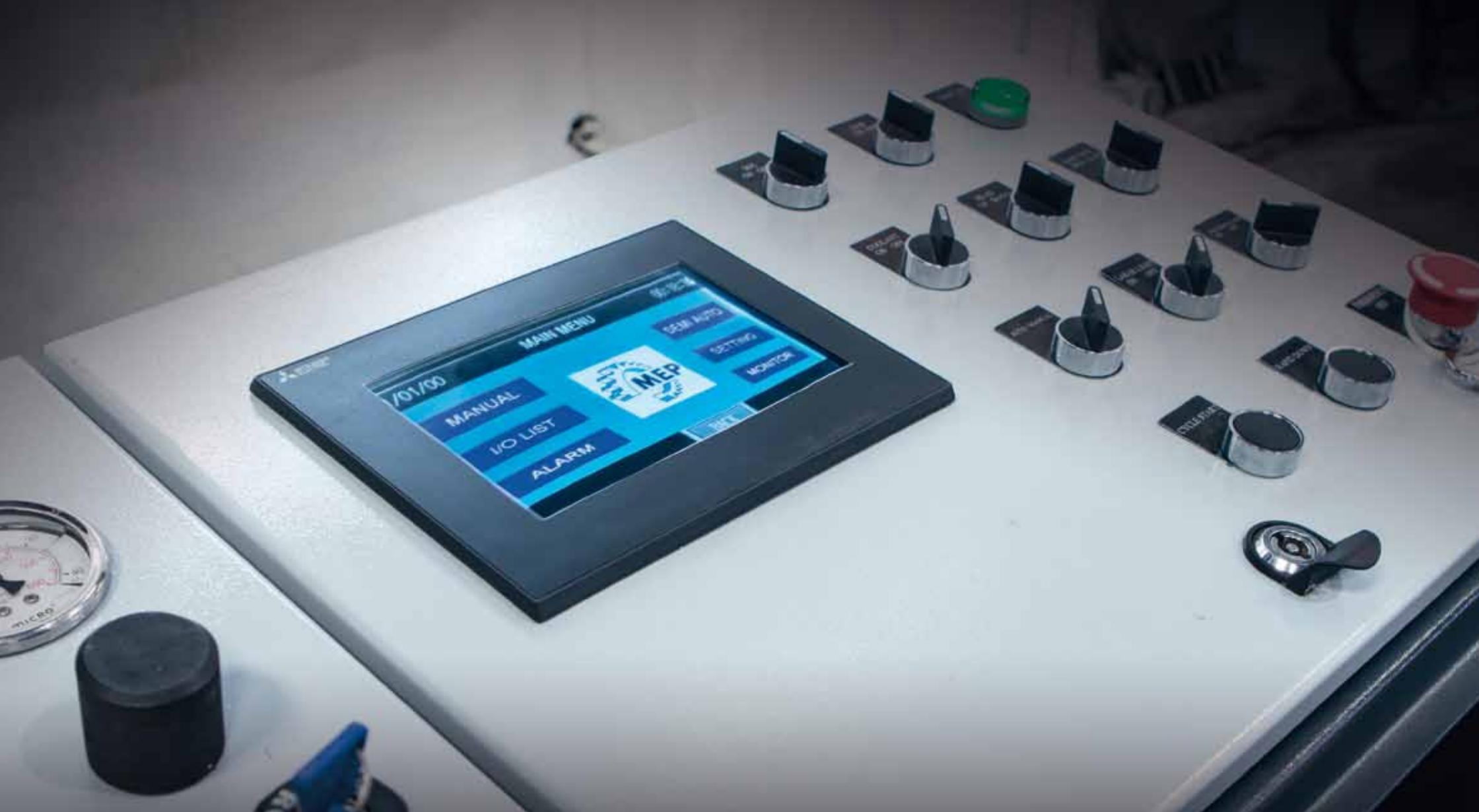
Controllo generale della macchina con pulsanti di comando, PLC, inverter elettronico per la variazione dei giri della lama, ■
