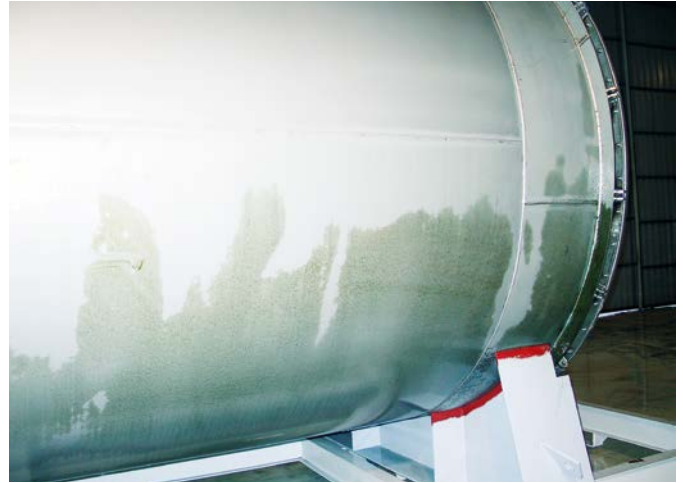
Contaminazione ferrosa dopo decapaggio (macchie scure sulla superficie).
