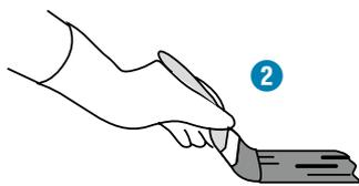
3. Lasciare agire il Gel per 30 minuti fino a 4 ore (a seconda della temperatura e del tipo di acciaio). La temperatura della superficie deve essere sempre superiore a +5 °C.
