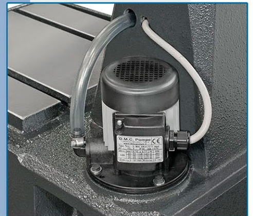
Impianto di refrigerazione • Système d'arrosage • Cooling system • Kuehlanlage
