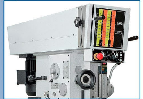
VAR.R (Variatore ritardo) • VAR.R (Variateur par engrenages) • VAR.R (Speed variator with gears) • VAR.R (Stufenlos mit Getriebe)
