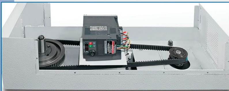
Trasmissione con variatore elettronico (Speedtronic) Modd. 13/18/22/25/30/35/40/45 • Trasmissione con variatore elettronico • Variation des vitesses par variateur électronique • Electronic speed variator • Elektronische Stufenlos
