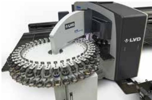
Capacità aumentata per utensili e cambio utensile automatico.
