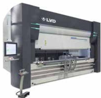
**Pressa piegatrice idraulica ricca di funzionalità con cambio utensile automatico integrato.**
